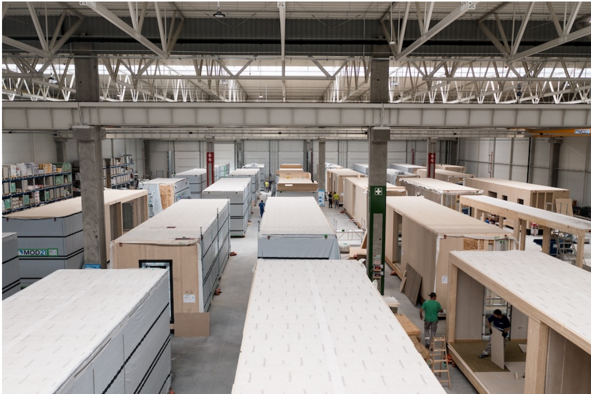
Abb. 2: Zeitersparnis durch Vorfertigung im Werk. Während die Baustelle vor Ort noch vorbereitet wird, warten im MOD21 Werk bereits die ausgebauten Module auf ihren Transport. Die Vorfertigung ermöglicht eine Umsetzung in höchsten Qualitätsstandards, da in einer witterungsgeschützten Umgebung gearbeitet wird.
